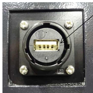
データ送信用 USB メモリー挿入口 (フタを取った状態)
